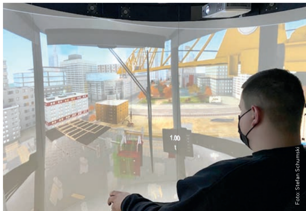
Die 180 Grad Projektionsfläche des Kran-Simulators ermöglicht eine gefahrlose Schulung. Die vielseitige virtuelle Umgebung simuliert unterschiedlichste Baustellenszenarien und Umwelteinflüsse.
