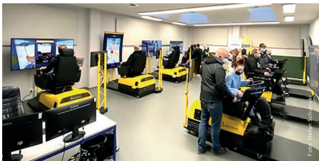
An den acht herstellerneutral gebauten Maschinensimulatoren können die Auszubildenden im ABZ Oberhausen gleichzeitig und gemeinsam auf einer virtuellen Baustelle arbeiten.
