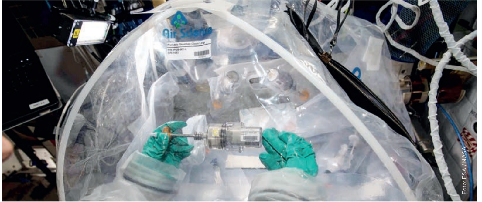
Zum Schutz vor Verunreinigung der Raumstation wird das Experiment in einer Handschuhkiste (Glove Box) durchgeführt. 64 Betonzylinderproben werden so von Matthias Maurer hergestellt.
