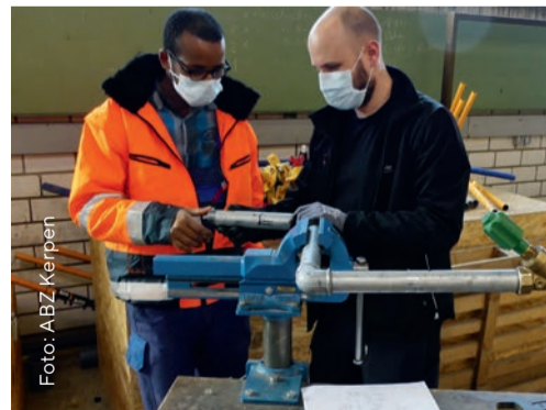
Wie hanft man ein verzinktes Stahlrohr ein? Mit großer Aufmerksamkeit folgt Mamaudou Bassoum (links), Auszubildender bei der Horstmann GmbH in Mülheim, den Erklärungen und Handgriffen seines Ausbildungsmeisters Mario Monterosso.
